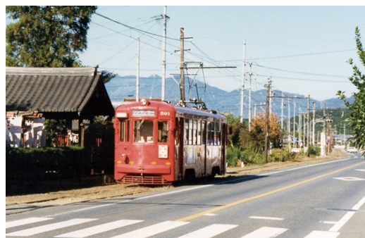
図2 幅員が狭い道を取る地方では道路の片側に寄せて敷設された。初期の電気軌道の姿をとどめていた今はなき名鉄美濃町線。神光寺停留場付近にて1997年11月7日撮影
